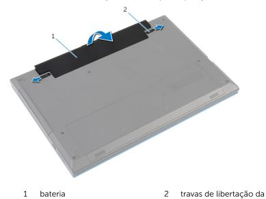
**3** Com as pontas dos dedos, levante a bateria em ângulo e remova a bateria da base do computador.
